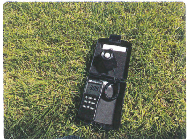
安裝後照度測試
